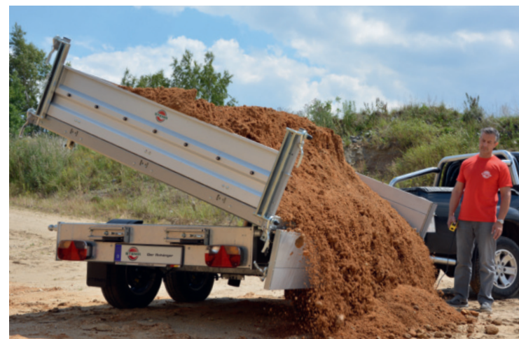
allseitig abklapp- und abnehmbare Bordwände
