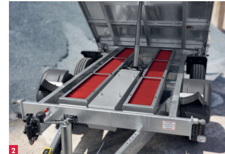
verzinkter Stahlblechboden mit versenkten Schwerlast-Zurringen
