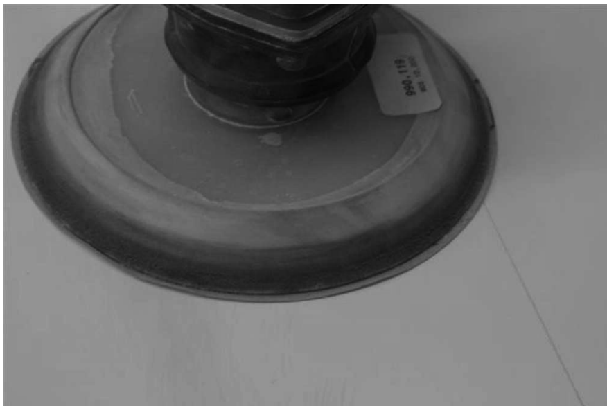
Abbildung 20 — Letztes Abschleifen mit feiner Körnung
