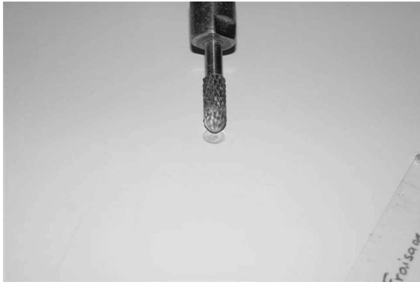
Abbildung 4 — Ausfräsen oder Abkratzen
