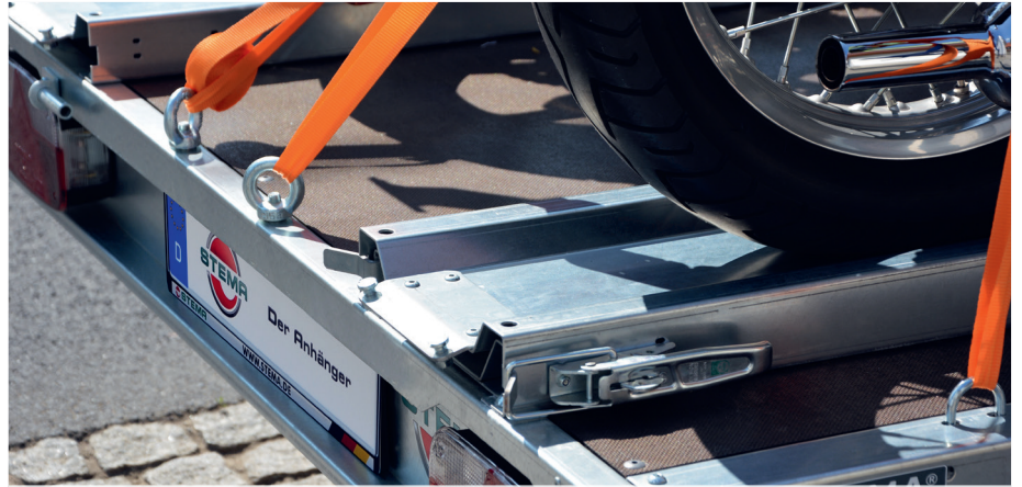
STLP 850 verfügt über vier zusätzliche versenkbare Verzurrbügel
