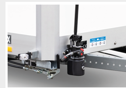
Der Sicherungshebel der Handpumpe rastet automatisch ein sobald die Fahrposition erreicht ist.
