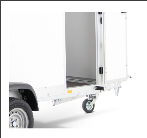
Barrierefreie Einstiegstür ohne Stolperkante, rechts oder links
