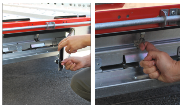
Abbildung: Auffahrschiene entnehmen
