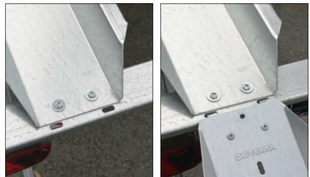
Abbildung: Auffahrschiene einhängen
