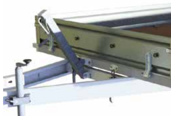
N18-380 m18 wer A: Spindelheber 700 kg
